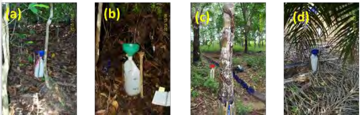
Gambar 9 Penempatan penakar throughfall padautupan lahan (a) hutan bekas tebangan, (b) hutan karet, (c) kebun karet dan (d) kebun sawit
