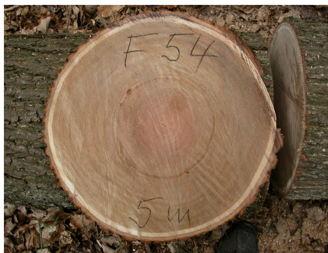
Abb. 1. Traumatische Ringschäle an einer Stammscheibe aus Parzelle F. Verfärbtes Rissereignis in Folge von starkem Frost aus dem Jahr 1956. Traumatic ring shake on a stem disk from lot F. Discolored detachment caused by frost in year 1956.
