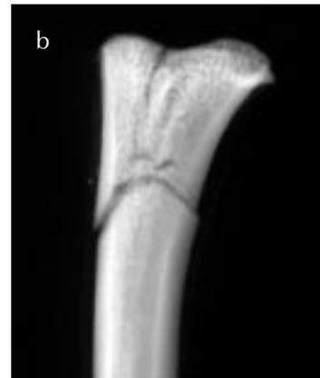
Abbildung 2: Feinfocusröntgenaufnahme einer typischen metaphysären Tibiafraktur nach Durchföhrung des Bruchtests: (a) seitliche Aufnahme nach Querbruch und (b) frontale Aufnahme, die die Komplexität des Frakturverlaufs zeigt, die nicht nur quer ist, sondern y-förmig nach oben auch in das Kniegelenk verläuft.
