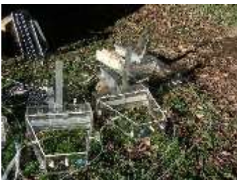
Abbildung 1 Kammer System für (CO 2 ) Boden-messungen
