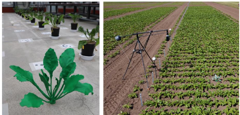
Auf dem linken Foto steht das 3D-Referenzmodell in einem Gewächshausversuch, rechts dient es als Referenz im Feld während einer Sensormessung.
