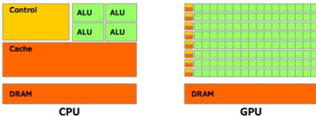
Abbildung 3.1: Architekturvergleich CPU, GPU
