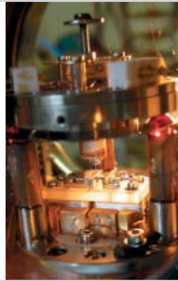
Abbildung 1: Das Grundprinzip des Rastertunnelmikroskops ist sehr einfach: zwischen einer sehr nah an die Oberfläche heran gebrachten Spitze und der Probenoberfläche fließt ein elektrischer Strom, der so genannte Tunnelstrom. Beim Abtasten der Probe wird der Abstand zur Oberfläche so geregelt, dass der Tunnelstrom immer gleich bleibt. Trägt man die Spitzenhöhe als Funktion der seitlichen Position auf, ergibt sich das Relief der Oberfläche. Dieses Relief wird Topographie genannt und entweder als 3D- oder als Farbstufenbild dargestellt. Das rechte Foto zeigt den »Messkopf« eines an der Universität Göttingen gebauten Rastertunnelmikroskops.
