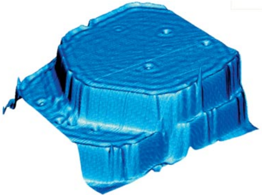
Abbildung 5: Interferenzmuster stehender Elektronenwellen auf einer Kupfer (111) Oberfläche. Zwei monatomare Stufen von je zwei Angström Höhe bilden Terrassen, die atomar glatt sind. Auf den Terrassen erkennt man ein Wellenmuster, welches durch Streuung der Elektronen an den Stufenkanten entsteht. Die Punktdefekte in den Terrassen sind durch gezielt eingebrachte magnetische Verunreinigungen (Kobalt) hervorgerufen
