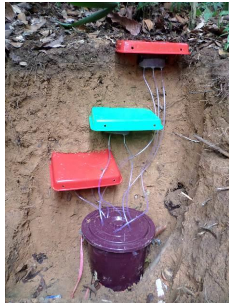
Instalasi selang ke botol kolektor
