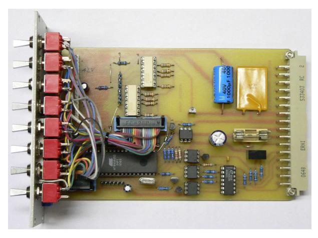
Alle Ausgänge sind Optokoppler-getrennt und geben je nach Versorgung 12 bis 24V mit ca. 1,7A aus (Kurzschlussfest).
