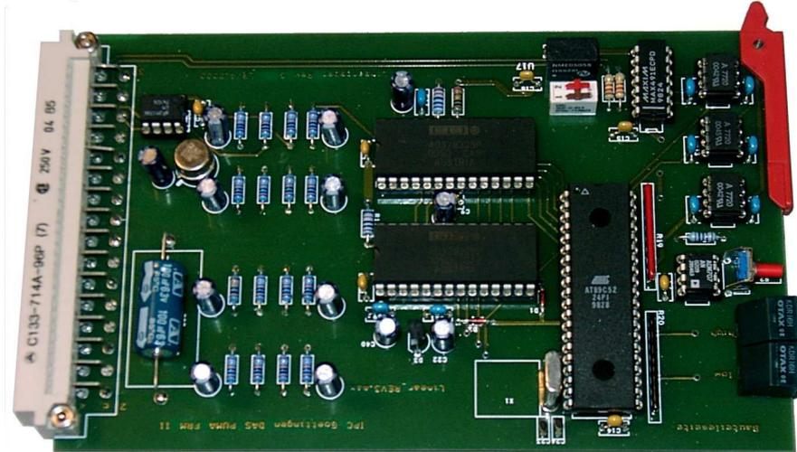
An eine Platine der Linearauswertung können acht Geber angeschlossen werden. Auf der Karte wird eine gepufferte 10V Referenzspannung erzeugt, mit der Potentiometer versorgt werden können. Maximale Strombelastbarkeit der Referenzspannung = 15mA. Das bedeutet, der parallel Widerstand aller angeschlossenen Geber darf 600 Ohm nicht unterschreiten. (Ausführung mit 741)
